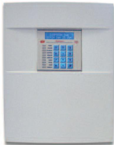
La centrale **DIAPASON DUO** dispose d'un coffret en ABS blanc et d'un clavier 12 touches avec afficheur LCD de 2 fois 16 caractères. Elle intègre une alimentation 230 Vca (50Hz) / 12 Vcc 0,7 A. Elle se raccorde au secteur directement sur le bornier prévu à cet effet. Le coffret permet de recevoir une batterie 12V / 7Ah (réf. SP070) permettant de garantir une autonomie de fonctionnement au système d'au moins 36 heures en cas de coupure secteur.
