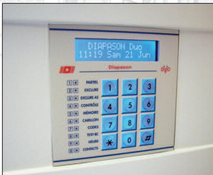
système bidirectionnel DUO fréquences 433/868 MHz par
