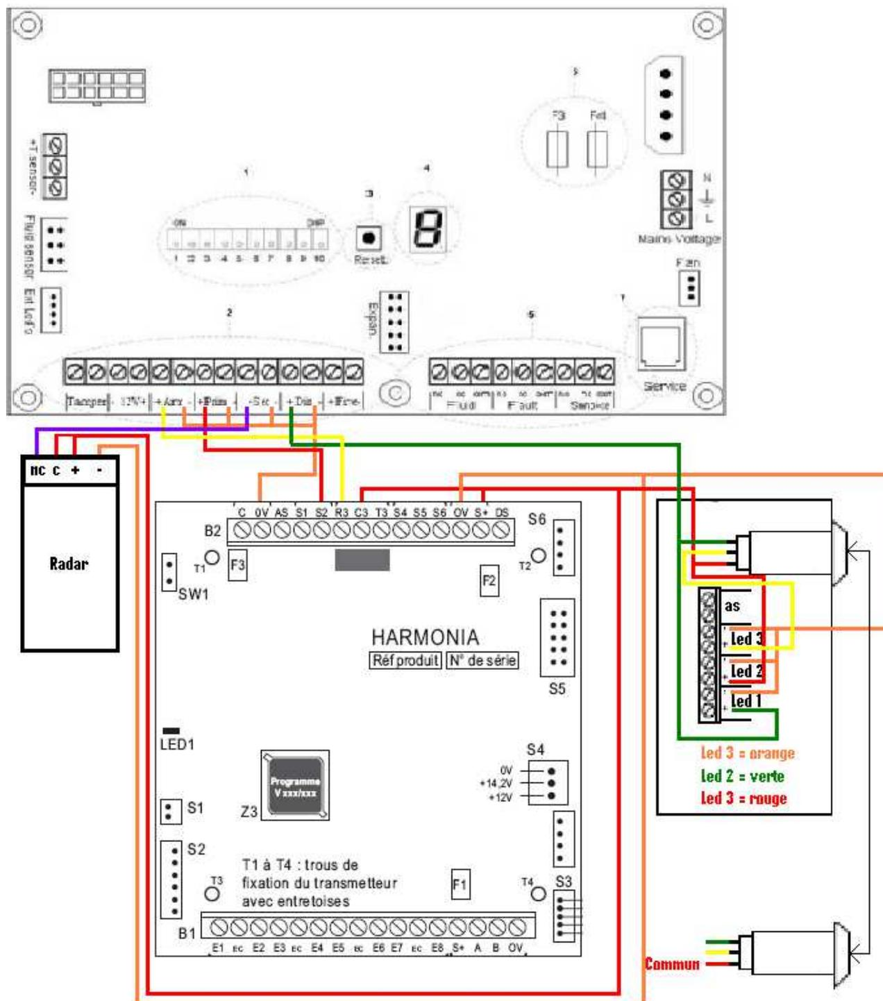
La sortie 2 est déjà programmée en sirène intérieure en positif. Il n'est pas nécessaire de la reprogrammer.
