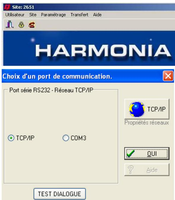
A partir du logiciel, ouvrez un site puis dans le menu « Transfert », sélectionner « Choix du port de communication »
