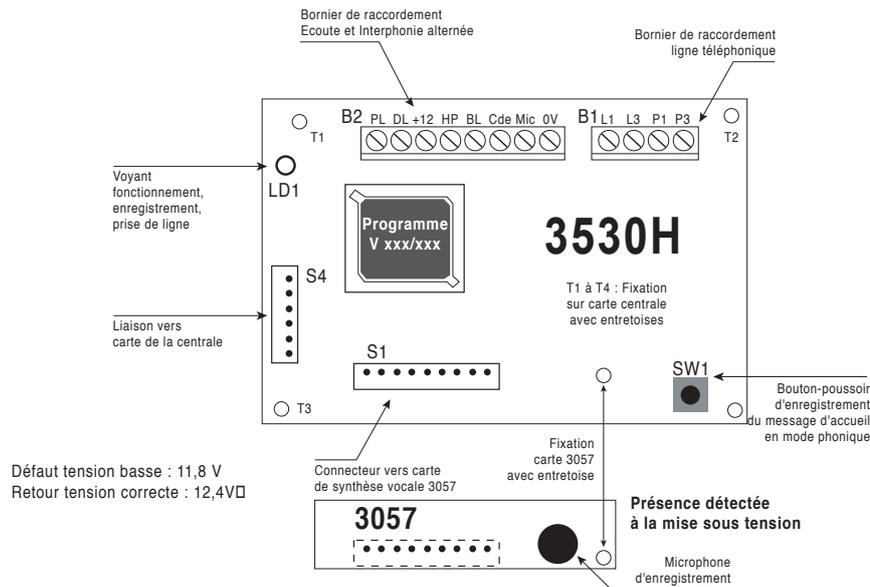
Fig. 12e : Raccordement de la ligne téléphonique
