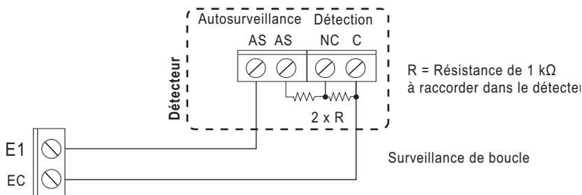
Fig. 23 - Raccordement de 2 détecteurs et 2 autosurveillances
