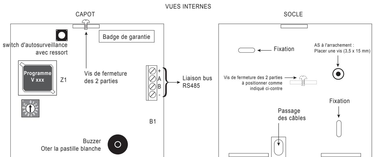
Seules les adresses 0, 1, 2 et 3 sont autorisées pour les claviers raccordés sur les centrales 2650 et 2660, et 0 à 7 pour ceux raccordés sur les centrales 2680.
