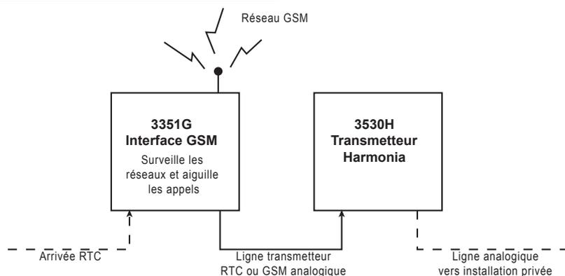
Raccordement derrière une ligne analogique reconstituée (Autocom, boîtier ADSL, boîtier sur ligne Numéris)
