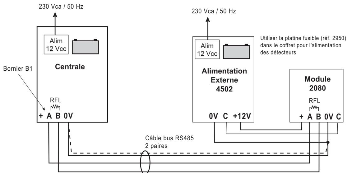
Dans ce cas, la présence secteur est gérée par le module 2080. Dans le cas contraire, la borne C de l'alimentation 4502 doit être raccordée à DS de la centrale (B2).
