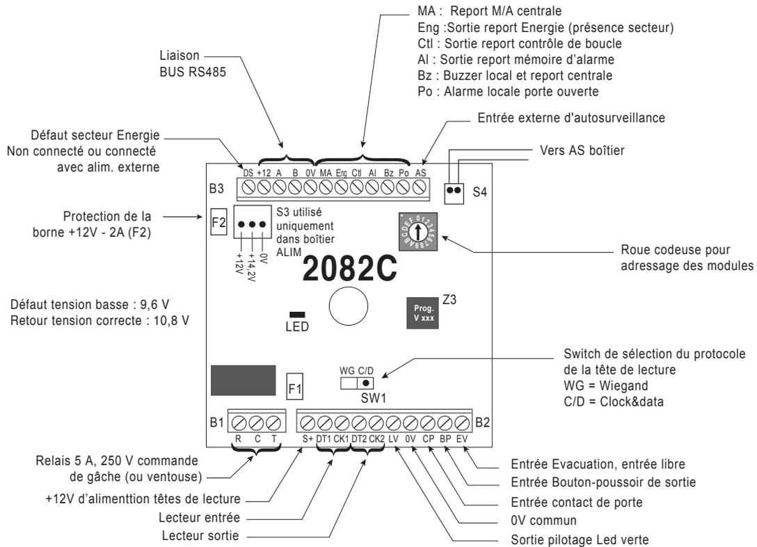
**Important** : Vérifier la compatibilité des têtes de lecture qui doivent être alimentées en 12 V . L'autosurveillance doit être gérée par un contact sec ou un 0 V commun avec l'autosurveillance de la carte..
