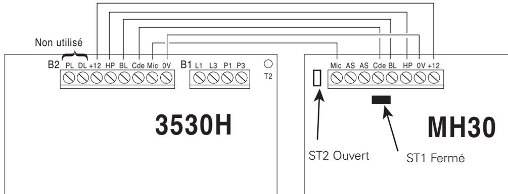
Fig. 12g : Raccordement écoute seule avec micro ME30 (**avec strap ST2 ouvert**)
