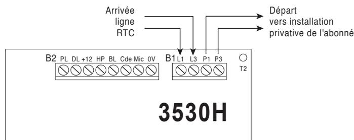
Lors d'une transmission d'alarme, le transmetteur coupe la liaison privative de l'installation et devient prioritaire sur la ligne RTC. Il ne faut en aucun cas brancher un équipement en parallèle sur la ligne arrivée RTC (borne L1 et L3).
