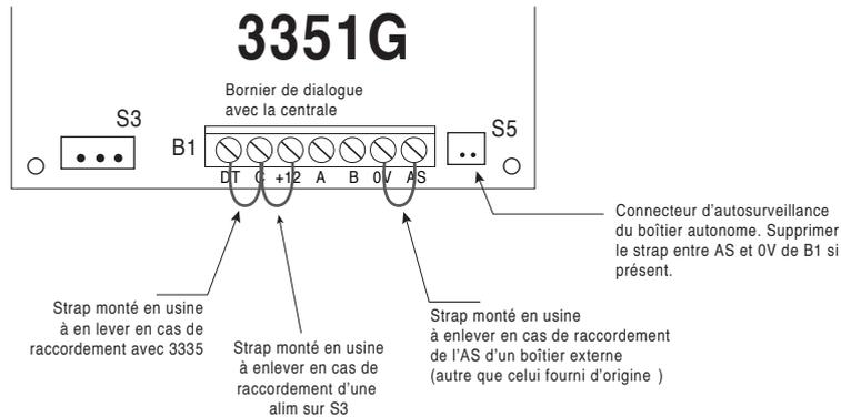
Sur un 4520P, mettre en série les autosurveillances à l'ouverture et à l'arrachement, et raccorder l'ensemble entre "0V" et "AS" du bornier B1 à la place du strap monté en usine.
