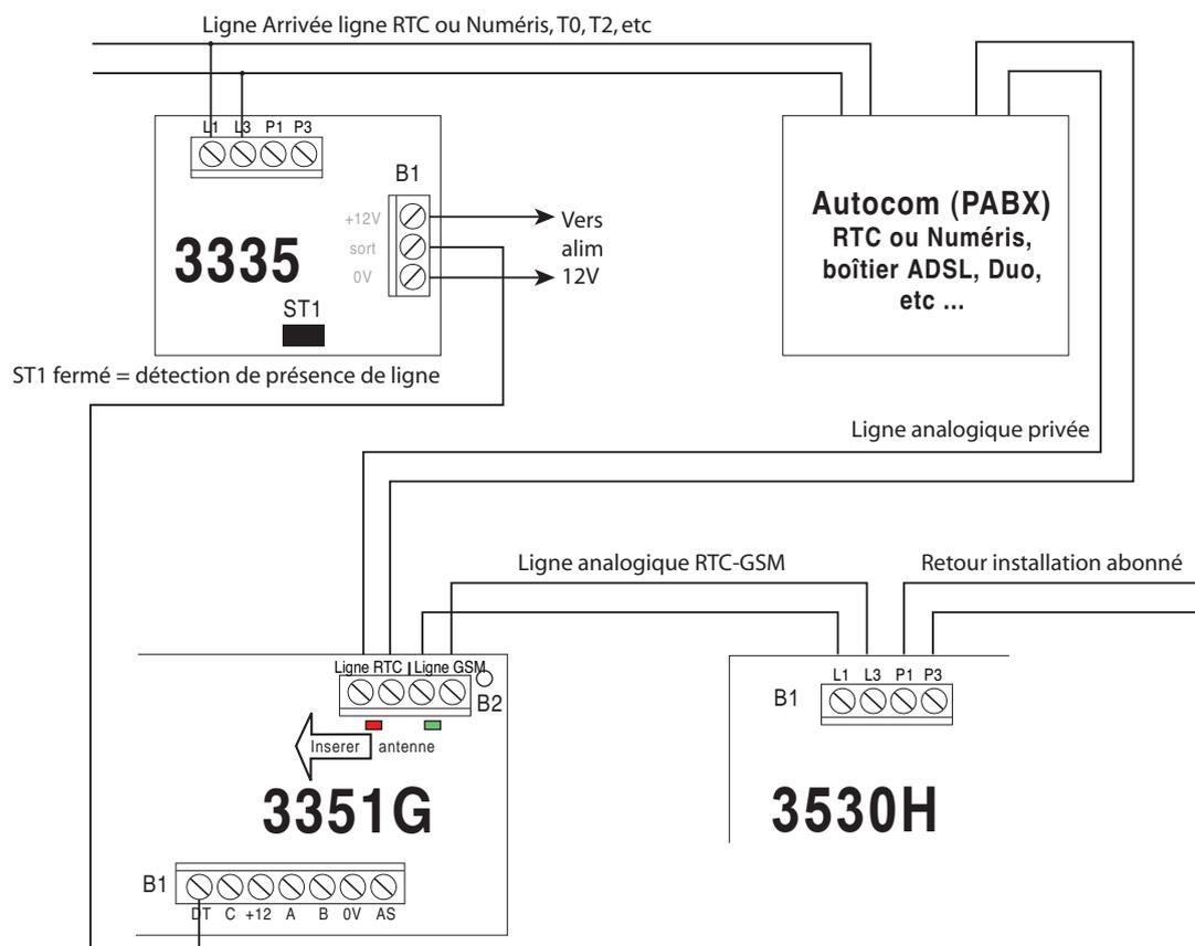
Supprimer le strap raccordé entre les bornes Dt et +12V (monté en usine)
