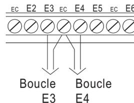
**Longueur maxi d'une boucle : 100 m.** C'est la distance maximale autorisée entre l'entrée physique de la centrale (ou du module E/S) et le détecteur (ou le détecteur le plus éloigné).
