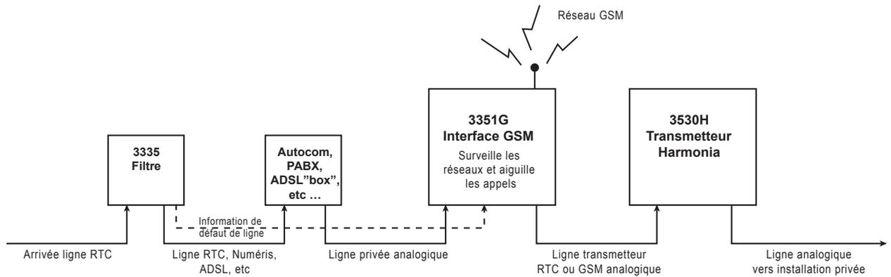
Le module 3335 surveille la ligne filaire en amont et signale directement au 3351G un défaut de ligne RTC.
