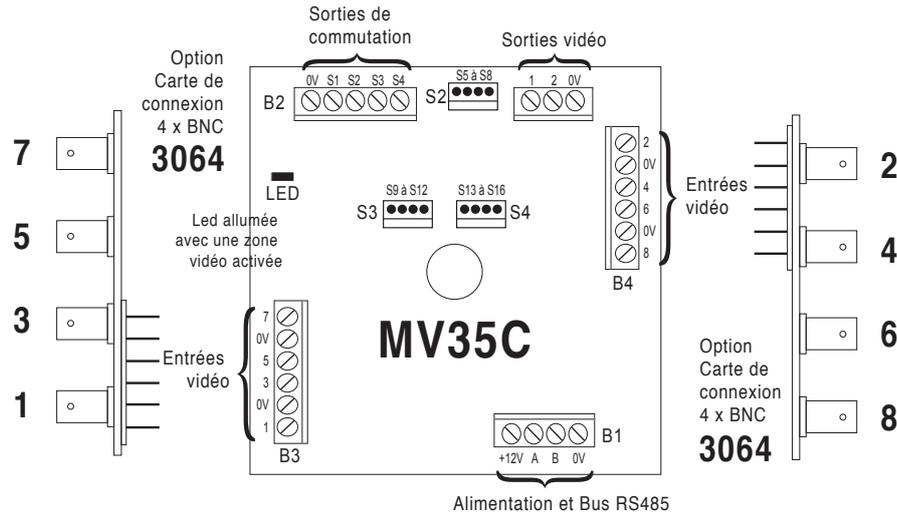
**Précaution :** Les entrées vidéo sont compatibles avec un signal vidéo 75 Ohms / 1V maxi. Risque de détérioration en cas de tension supérieure.
