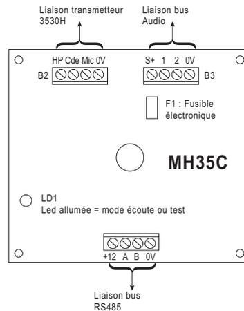
**Important :** La liaison entre l'interface MH35C et le transmetteur 3530H ne doit pas excéder 10 m.
