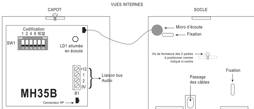
**Important :** Dans tous les cas, le voyant doit rester visible. Installer le boîtier à 1,5m de hauteur. Éviter le montage dans un placard ou une trop petite pièce (saturation du signal)
