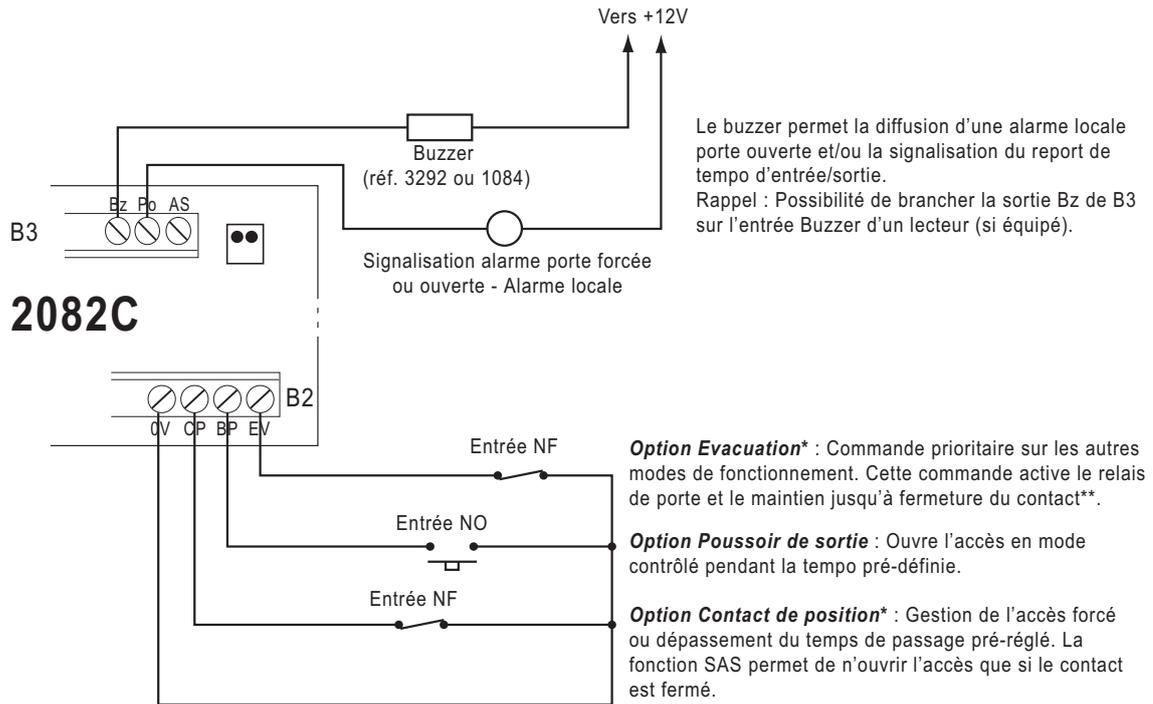
\* : Si les fonctions évacuation et contact de position ne sont pas utilisées, les bornes respectives doivent être reliées au 0V.
