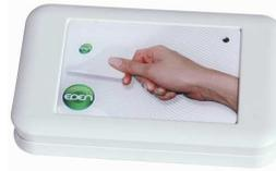
Pour encoder des badges (type MIFARE®) compatibles avec le CBMPROX485 / SOLO, vous devrez disposer d'un encodeur USB (référence ENCOD-USB, cet encodeur ne nécessite aucun pilote). Pour le mettre en service dans SenatorFX.NET, cliquez sur l'onglet « Technique », « configuration du site » et procédez comme suit :
