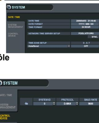
Protocol utilisé pour les clavier de la gamme KD-XXX: ICK-3000. Renseigner le débit inscrit sur l'écran LCD du joystick dans le champ "BAUD RATE" du menu "PERIPH COMMANDE".
