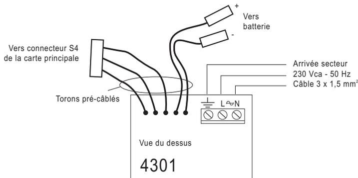
Alimentation à découpage régulée en tension et limitée en courant. Ce système à découpage permet un rendement énergétique important à une consommation moindre. Elle dispose d'une liaison pré-câblée vers la centrale (connecteur S4) et une vers la batterie. Elle permet une charge de la batterie en floating avec un système de limitation de courant
