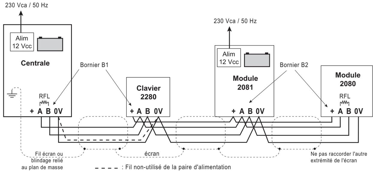
**Conseil :** Le fil non-utilisé de la paire d'alimentation est raccordé au 0 V commun. Les fils non-utilisés du bus doivent toujours être raccordés au 0 V commun. Ne jamais brancher les alimentations "en parallèle", seul les 0 V doivent être communs.
