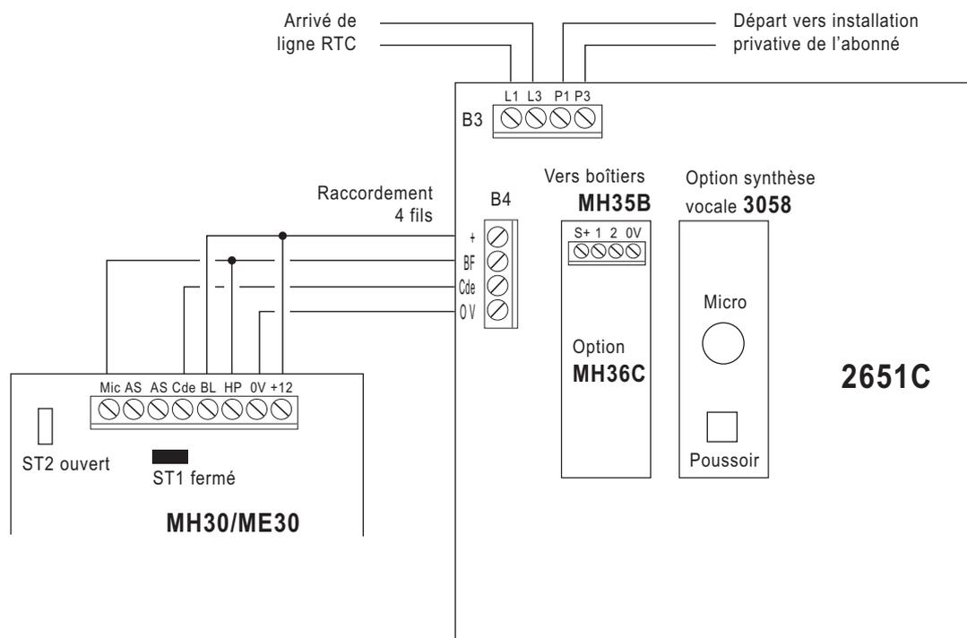
Lors d'une transmission d'alarme, le transmetteur coupe la liaison privée de l'installation et devient prioritaire sur la ligne RTC. Il ne faut en aucun cas brancher un équipement en parallèle sur la ligne arrivée RTC (borne L1 et L3).
