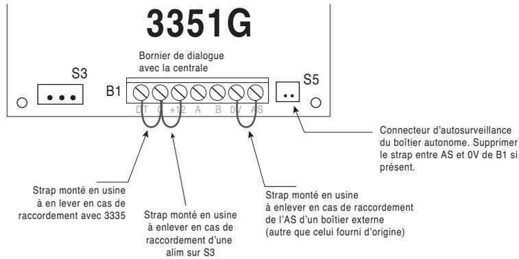
Mettre le connecteur AS sur S5 et ôter le strap présent entre "0V" et "AS" du bornier B1
