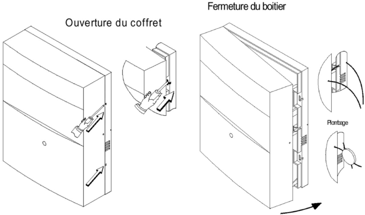
Se reporter au module 2080 pour le détail de la carte électronique. Le boîtier du 2081 est protégé à l'ouverture et à l'arrachement. Utiliser le boîtier comme gabarit de fixation. La vis pour l'autosurveillance à l'arrachement doit dépasser du mur de 7 mm
