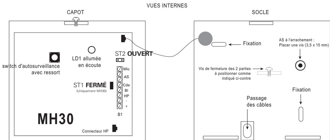
**IMPORTANT** : Le cavalier ST1 doit impérativement être FERMÉ et le cavalier ST2 doit impérativement être OUVERT
