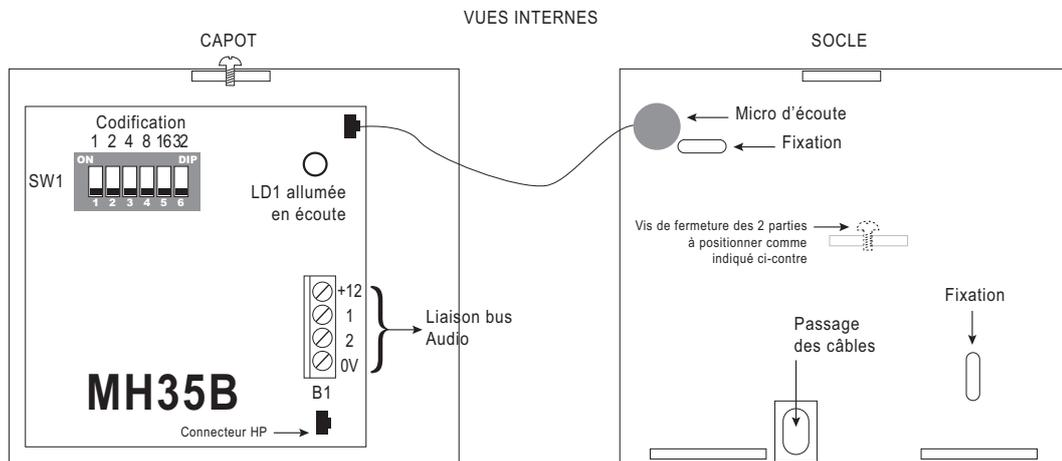
**Important :** Dans tous les cas, le voyant doit rester visible. Installer le boîtier à 1,5m de hauteur. Eviter le montage dans un placard ou une trop petite pièce (saturation du signal)
