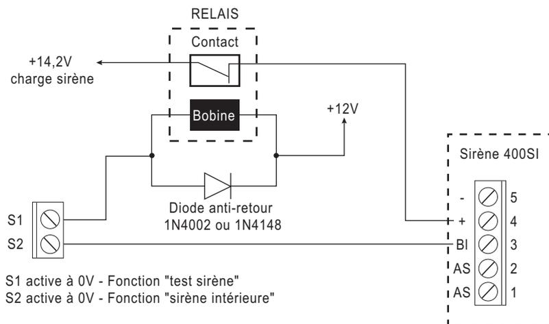
Fig. 29 - Raccordement sur la centrale obligatoire en NF & A2P
