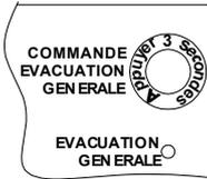
Déclencher manuellement les fonctions de mise en sécurité (compartimentage, désenfumage...) en appuyant sur les touches « commande manuelle » des fonction n°1, n°2 et n°3
