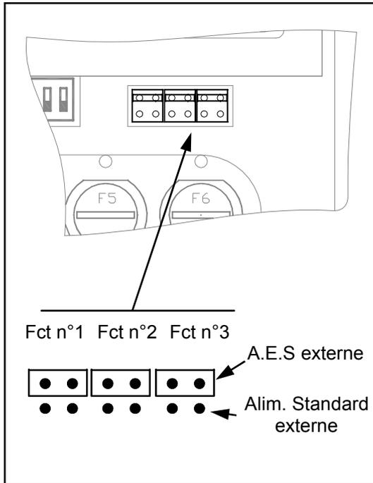
• La puissance électrique nécessaire à la télécommande des D.A.S. ne peut être fournie que par une des deux alimentations extérieures.
