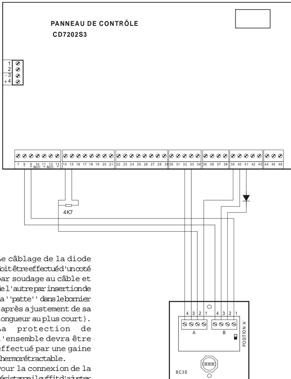
Le câblage de la diode doit être effectué d'un côté par soudage au câble et de l'autre par insertion de la 'patte' dans le bornier (après ajustement de sa longueur au plus court). La protection de l'ensemble devra être effectuée par une gaine thermorétractable. Pour la connexion de la résistance il suffit d'ajuster les longueurs de ses connexions au plus court et de les placer dans le bornier, de même que pour le câble.
