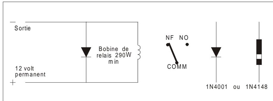
3. Si le relais doit commuter le courant secteur de 220 V, NE PAS le monter à l'intérieur de la centrale de commande.
