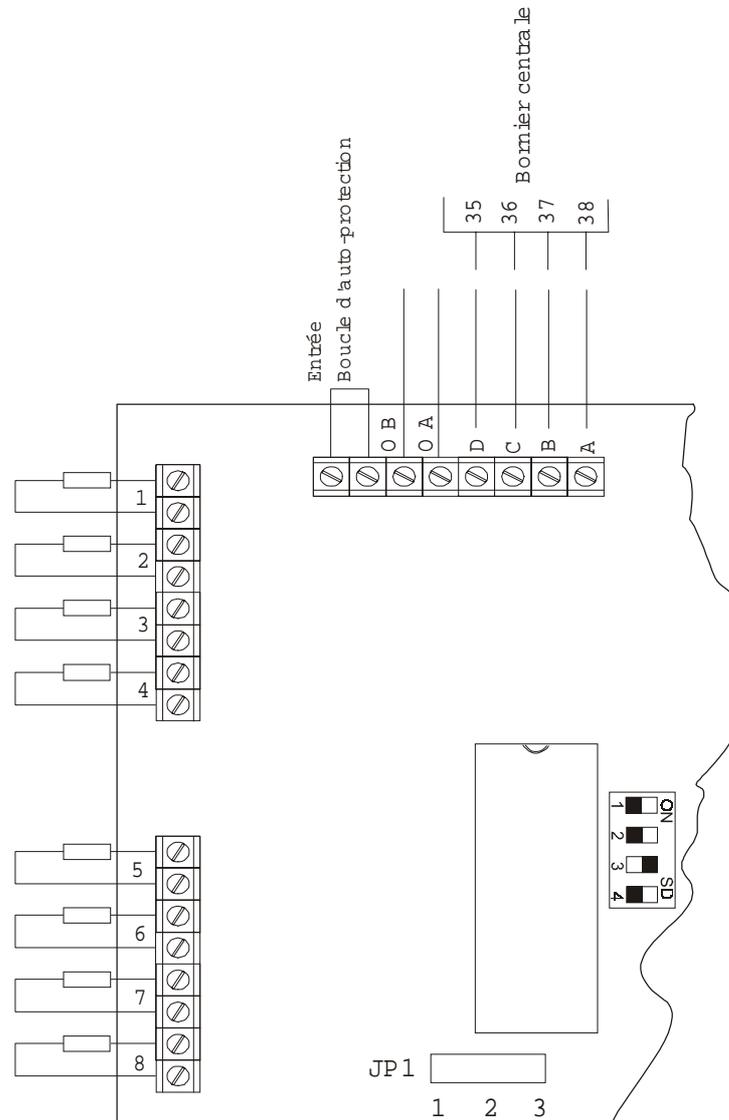
Le raccordement du module d'extensions 8 zones CD9031S33 s'effectue sur le bus de communication des claviers (bornes ABCD).
