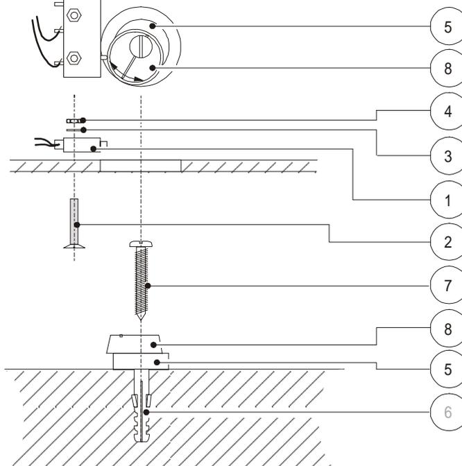
A. Fixer le contact anti arrachement (1) au fond de la centrale dans la position telle qu'indiquée sur le schéma avec la vis (2) la rondelle (3) et l'écrou (4).
