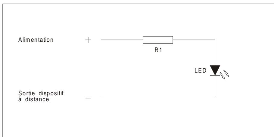
**Montage de blocs d'alimentation auxiliaires**
