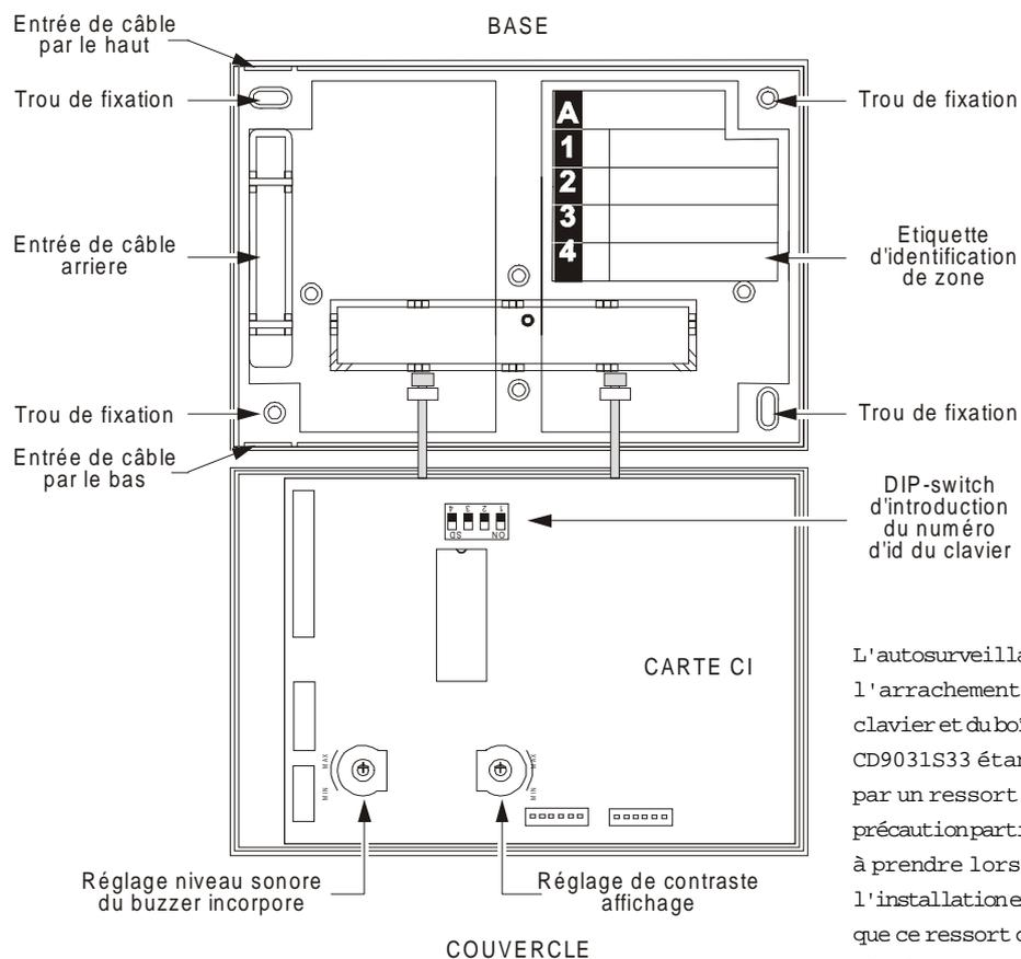
L'autosurveillance à l'arrachement de ce type de clavier et du boîtier CD9031S33 étant assurée par un ressort aucune précaution particulière n'est à prendre lors de l'installation exception faite que ce ressort doit simplement être en appui sur le support du clavier.
