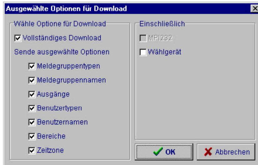
3. Markieren Sie alle Punkte, die Sie in die Einbruchmeldezentrale laden möchten.
