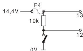
Principe d'opération d'une centrale de type NF-A2P. Le schéma montre la sortie sirène extérieure hors alarme.
