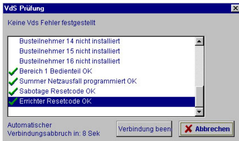
Nach Ablauf der VdS-Prüfung, wird die Verbindung automatisch nach einigen Sekunden unterbrochen oder kann sofort mit der Schaltfläche „Verbindung beenden“ unterbrochen werden. Sofern gewünscht kann der Verbindungsabbruch auch mit der Schaltfläche „Abbrechen“ verhindert werden.
