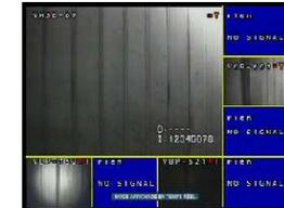
**Par exemple, nous allons mettre l'image de la VLP152( caméra N°5) à la place de l'image du dôme VHSD-87(caméraN°1)**
