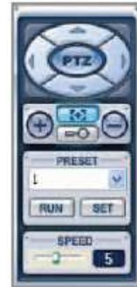
Vous pouvez maintenant : pour les appareils (dômes motorisés et caméras) ayant été répertoriés, et reconnus par le VXM4, Programmer à distance de nouvelles présélections. Appeler les positions présélectionnées Redémarrer par le réseau les fonctions 'Groupe, Excursions (Pattern) ou Balayage (Swing) Ajuster la vitesse du déplacement horizontal et vertical, vous pouvez ajuster celle-ci en modifiant SPEED.
