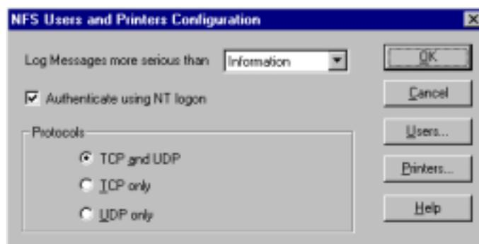
Vérifier que « *Log level* » est positionné sur « *Information* », que « *Authenticate using NT logon* » est coché, puis cliquez sur le bouton « *Users...* ». On accède à l'écran suivant :
